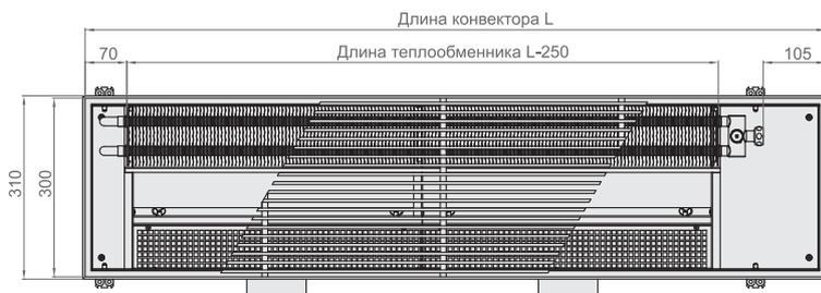
Вид сверху конвектора Ntherm Air 310.150 с роликовой решеткой, с U-образным бортом.
