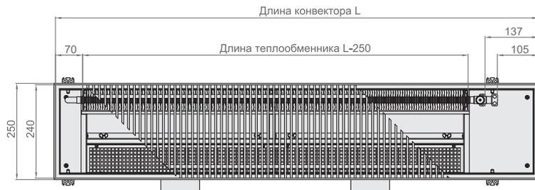
Вид сверху конвектора Ntherm Air 250.150 с роликовой решеткой, с U-образным бортом.
