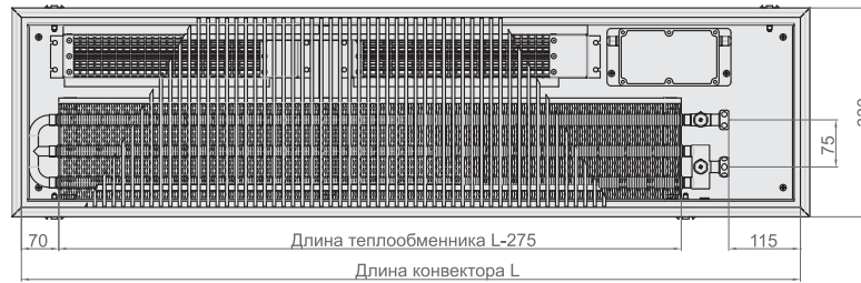
Вид сверху конвектора Qtherm 310 с роликовой решеткой, с F-образным бортом.
