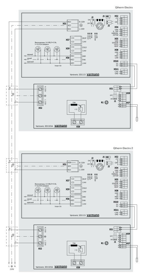
Ручная схема регулирования конвекторов Qtherm Electo позволяет плавно изменять и устанавливать нужную скорость вращения вентиляторов. Скорость устанавливается переменным резистором R1. При этом регулирование нагревом ТЭН, осуществляется в автоматическом режиме силовой платой управления ТЭН в зависимости от установленной температуры воздуха переменным резистором R2.
