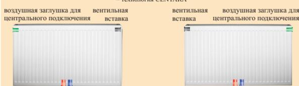
Ассиметричное подключение для сохранения одинакового расстояния между стеной и подключаемым блоком. Вентильную вставку и специальную воздушную заглушку можно легко поменять местами. Обратите внимание - питающая труба слева!
